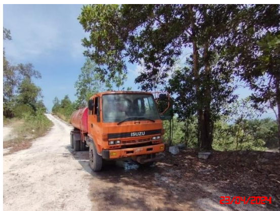
รูปที่ 3 รถฉีดพรมน้ำบริเวณเส้นทางขนส่งแร่
